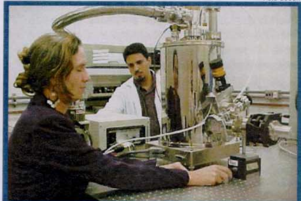
Os pesquisadores do Laboratório de Radiometria, Cláudia Monteiro e Augusto Cunha, explicam a importância do radiômetro Criogênico.
